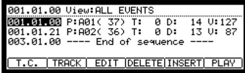
イベント・リストは上下カーソルキーによりスクロールします。また、カーソルがイベントタイム・フィールドにあるときは、DATAホイールを回すと、リストがスクロールします。
