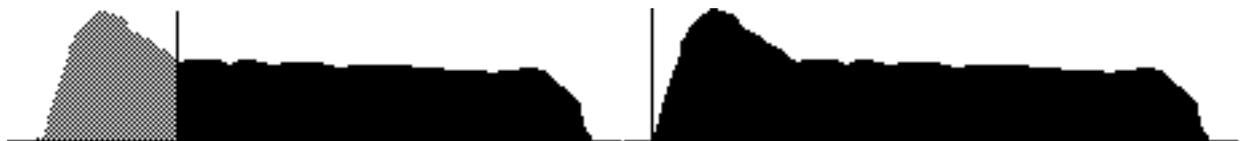
また、バイポーラのコントローラー（例、0で方向が反転するピッチベンドやLFO等）を使えばサンプル・スタートを両方向にコントロールできます。
